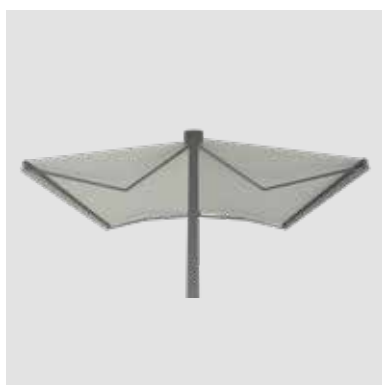
WINGLIGHT COMPACT Freistehende, doppelseitige Gelenkarmmarkise, mit einer Tuchwelle und einem Markisenantrieb, die synchron nach beiden Seiten ausfährt und Flächen bis zu 38,5 m 2 beschatten kann.
