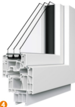
PRO Glas-Dämmwert: U_g 0,5 \text{ W/m}^2\text{K} Gesamt-Dämmwert: U_w 0,73 \text{ W/m}^2\text{K} Schallschutz: 35 dB Bautiefe: 88 mm
