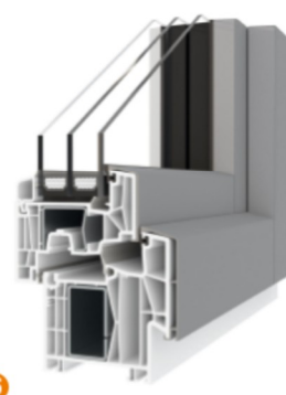
PRO Alu mit Falzrahmen Glas-Dämmwert: U_g 0,5 \text{ W/m}^2\text{K} Gesamt-Dämmwert: U_w 0,78 \text{ W/m}^2\text{K} Schallschutz: 35 dB Bautiefe: 94 mm
